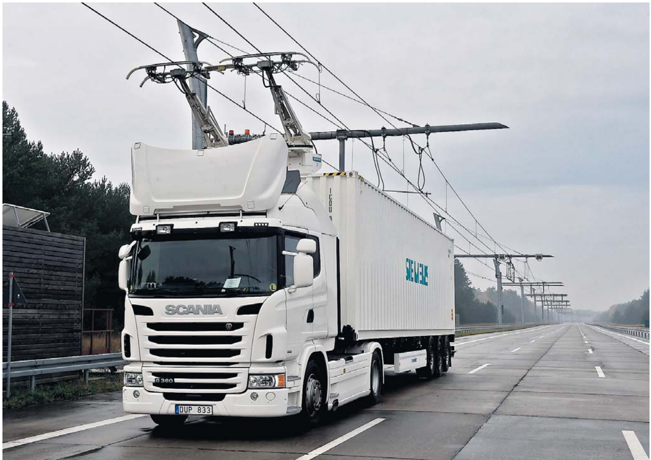
Ein Lkw mit Oberleitung auf einer Teststrecke in Brandenburg: Vielleicht gehören solche Bilder bald zum Alltag. Schon vor Jahren haben Experten vorgeschlagen, die Autobahnen A1 bis A9 komplett umzurüsten. Nun erhalten immerhin zwei Abschnitte versuchsweise Stromleitungen. FOTO: BERND SETTNIK/DPA
